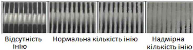
Рисунок 5.2 – Типи інію в морозильних камерах [10]
