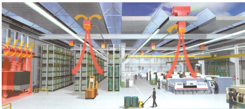
Рисунок 6.1 - Реалізація повітряного опалення в промисловому приміщенні
