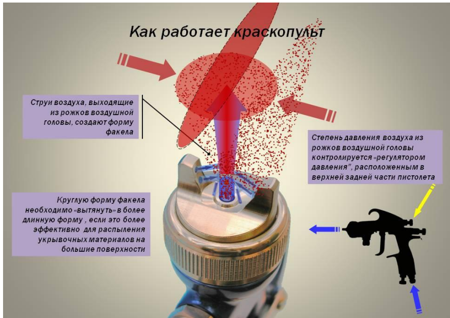
Рисунок 4.1 - Принцип работы фарбопульта
