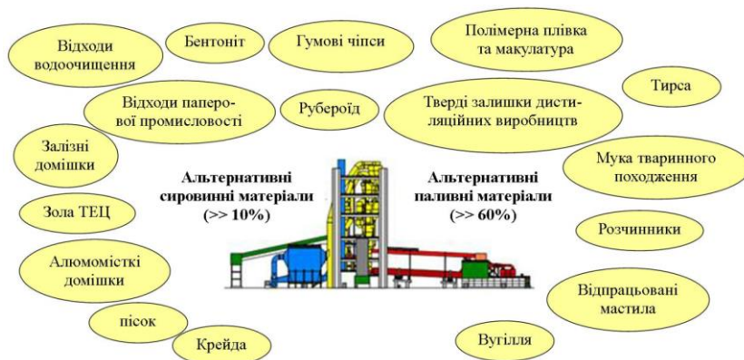
Рисунок 4.2 – Альтернативні матеріали, що застосовуються на заводі комбінованого способу в Lägerdorf (Німеччина)
