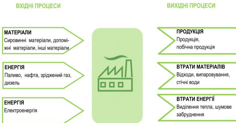
Рисунок 1.3 – Схема перетворення вхідної сировини в кінцеву продукцію та відходи
